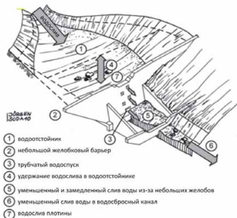
Схематическое изображение большого желобкового решетчатого барьера для дозирования и фильтрации (Рудольф-Миклау и Суда, 2011)
