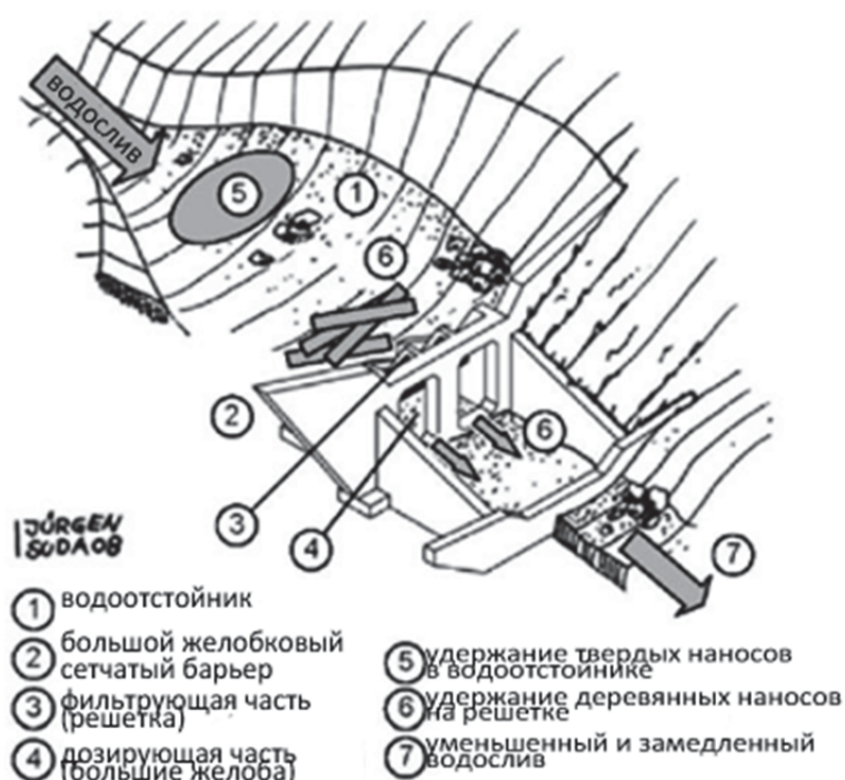
Схематическое изображение большого желобкового сетчатого барьера для дозирования и фильтрации потока (Рудольф Миклау и Суда, 2011)
