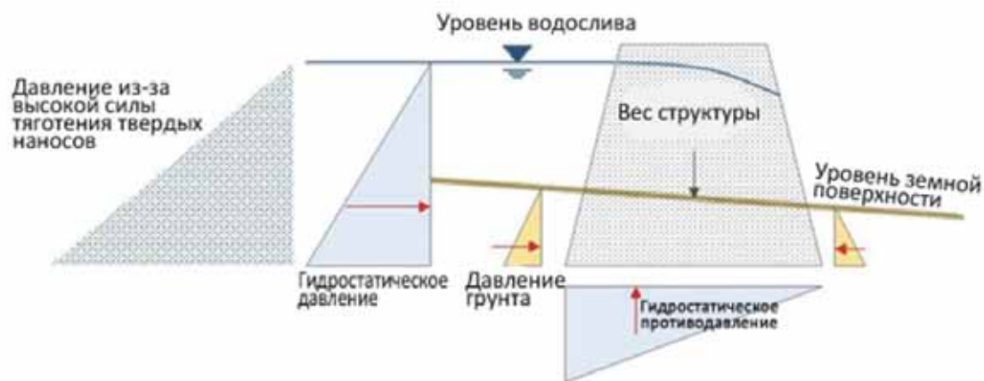
Рисунок 2 : Силы, воздействующие на габионные плотины, модифицировано согласно Ллано, 1
