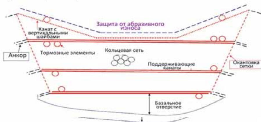
Схематическая конструкция гибкого барьера для грязекаменного потока (Венделер, 2016)
