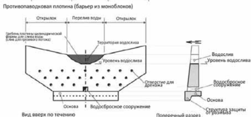
Схема типичной противопаводковой дамбы (Якоб и Хангр, 2005)
