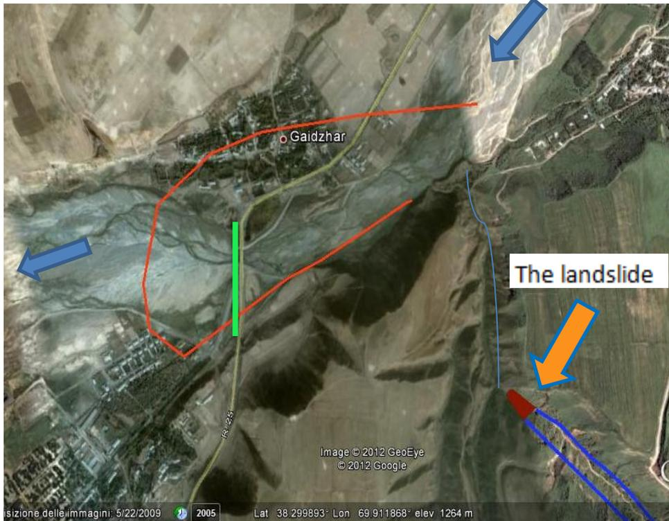
Существовал риск разрушения "Плотины" из-за эрозии поверхности с риском наводнения 200000 м<sup>3</sup> воды.
